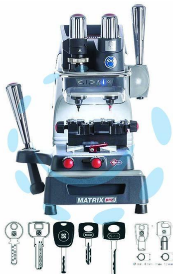
Chiavi cifrate con tastatore e fresino opzionali
