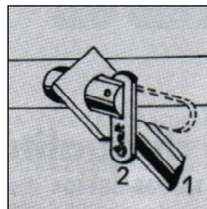
Gli innesti effettuati tramite i nottolini permettono di montare il trabattello senza bisogno di attrezzi e di bullonerie
