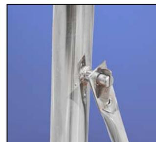
Gli innesti effettuati tramite i nottolini permettono di montare il trabattello senza bisogno di attrezzi e di bullonerie
